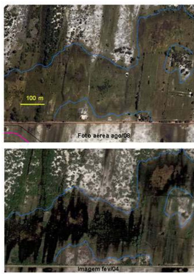
Foto 4.2.4-14 - Área de alagado temporário, em dois períodos do ano, observando-se também a influência da estrada (parte inferior) interrompendo o fluxo na área alagável
