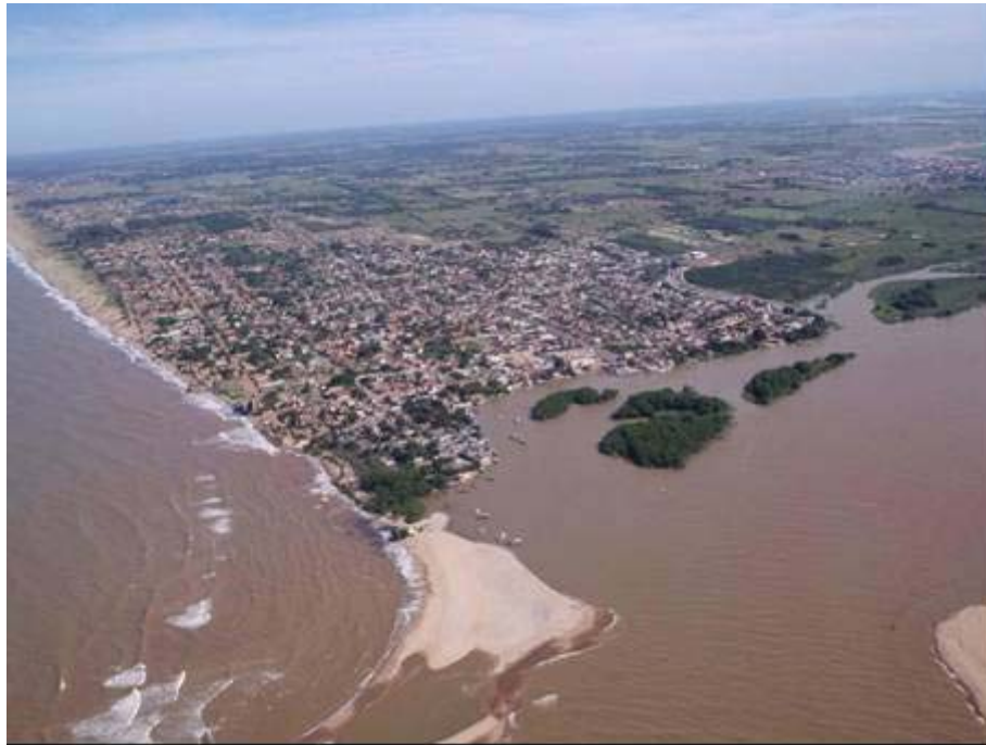
Foto 4.1-4 - Erosão marinha na AII (Foz do rio Paraíba do Sul - Atafona, São João da Barra)
