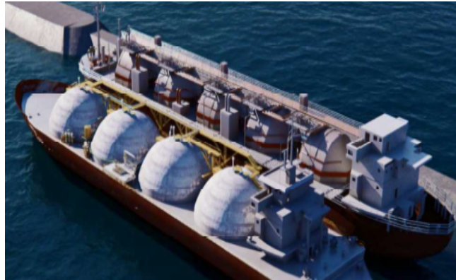
Exemplos de navio transportador de gás ( LNGC ), de transferência STS e de operação de FSRU .
